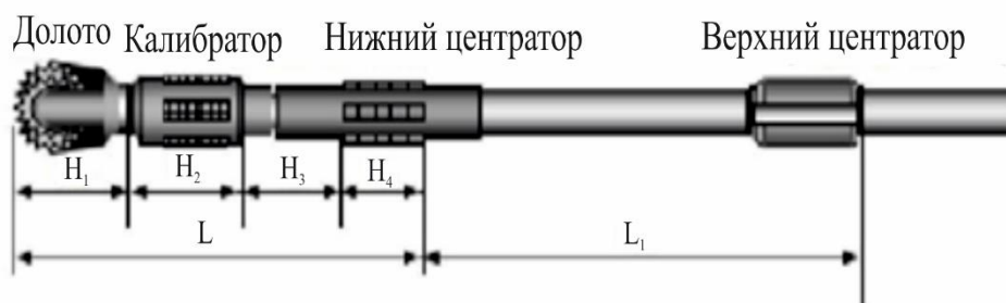
Рисунок 1. Расчётная схема КНБК с центраторами
