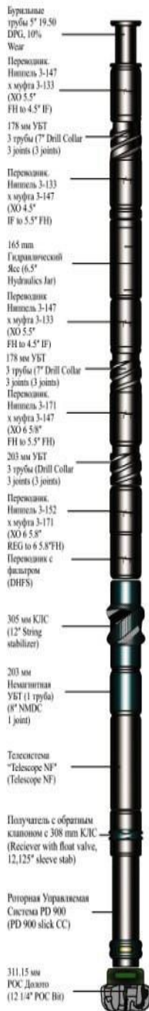
Рисунок 2. КНБК для бурения интервала 1650-2100 м (по вертикали) 1650-2119 м (по стволу) набора зенитного угла под техническую колонну
