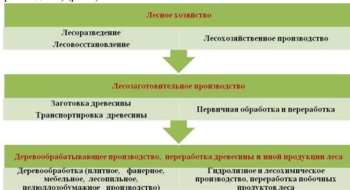
Рисунок 1 – Технологическая цепочка производств в лесном комплексе
