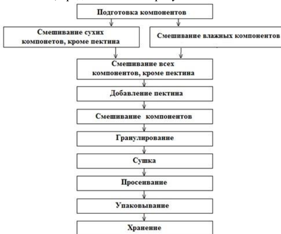
Рис. 2. Технологическая схема производства сухого концентрата напитка с добавлением женьшеня и элеутерококка
