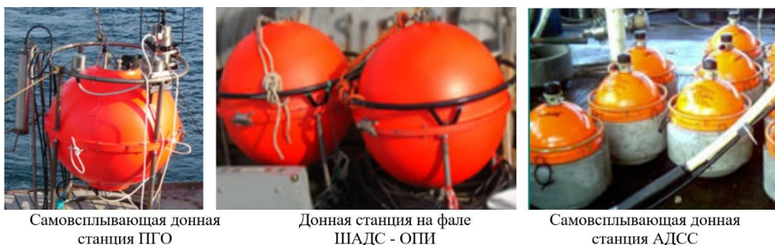
Рис. 2. Донные станции различного назначения для геологоразведки
