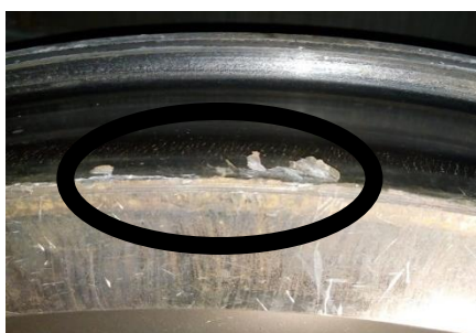
Рисунок 3 – Металлическая частица на поверхности катания колеса
