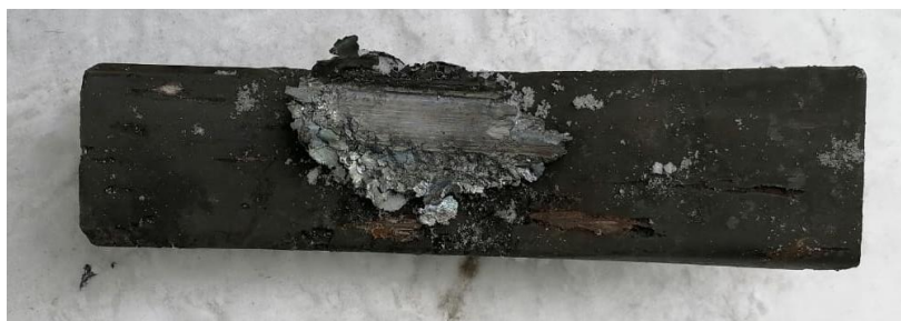
Рисунок 1 – Навар между колодкой и поверхностью катания колеса
