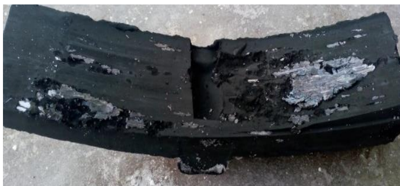
Рисунок 2 – Металлические включения в колодке
