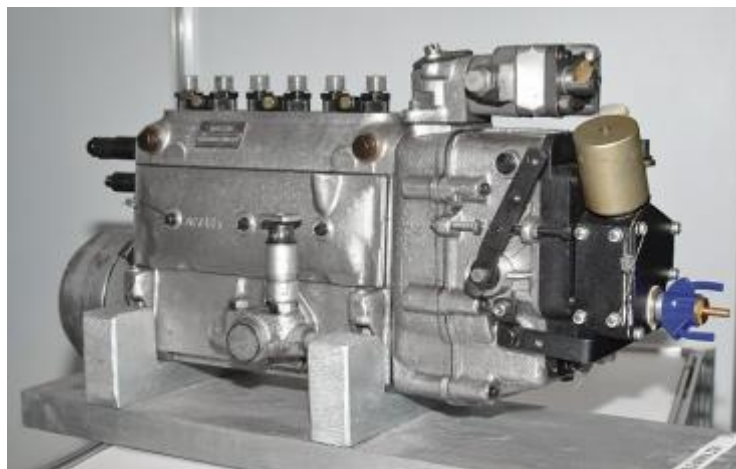
Рисунок 1.1 – Рядный ТНВД автомобиля MAN TG-A
